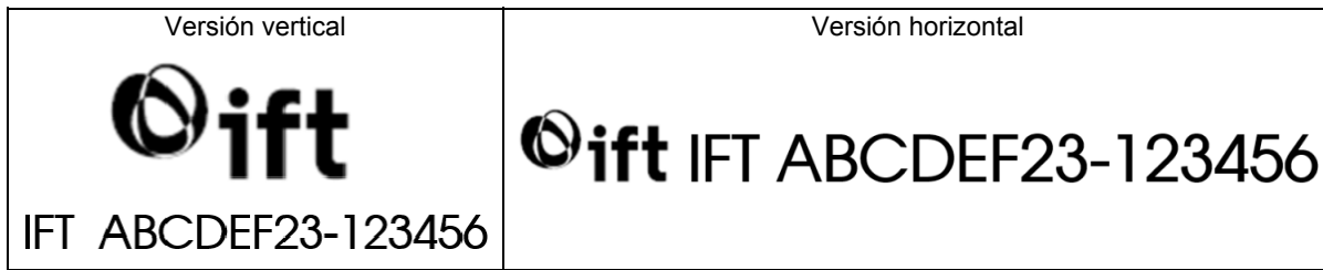
Figura 2.- Muestra gráfica de uso del Sello IFT, las siglas “IFT” en mayúsculas y el número de Certificado de Homologación, en el marcado o etiquetado de Productos homologados.
